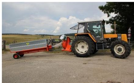
Soufflerie à copeaux sur prise de force pour tracteurs à partir de 60 CV Pdf 540-750 tr/mn Cat 2 arbre 1"3/8
