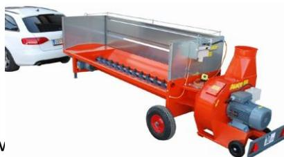
Vis de convoyage version tractée/Largeur d'auge 2,80 m/Roues gonflables diam 470 mm/B =100 mm
